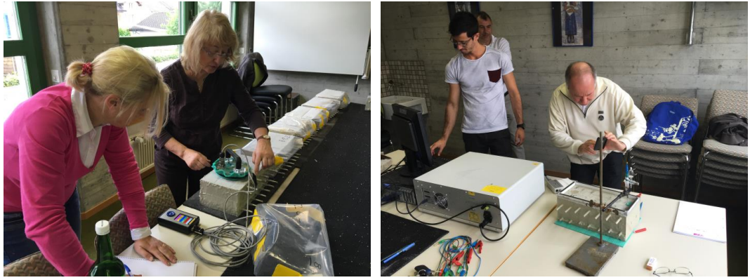
Abb. 28 Messungen mit Gecor-10 (links) und mit der Ausrüstung des IfB der ETHZ.
