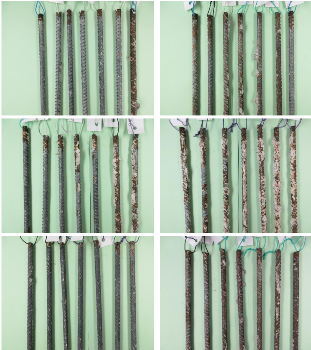
Abb. 97 Zustand der Stahlstäbe direkt nach dem Ausbau. Von links bis rechts: Stab 7 bis Stab 1. Oben: PK01 (links) und PK01K (rechts), Mitte: PK04 (links) und 04K (rechts). Unten: PK05 (links) und 05K (rechts).
