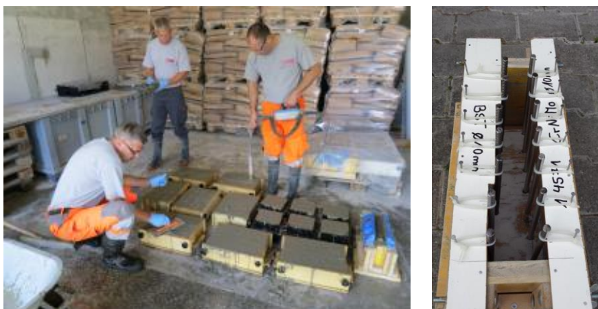
Abb. 22 Herstellung der Prüfkörper Serie 2016.
