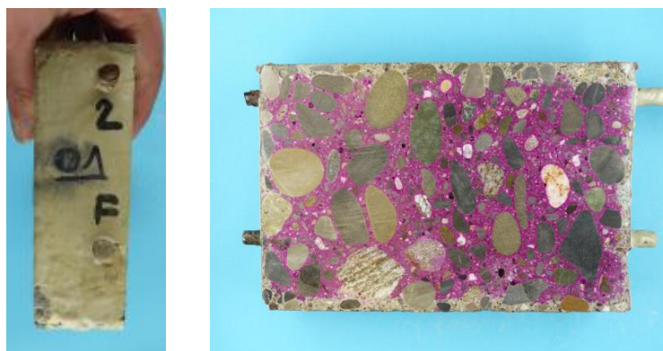
Abb. 95 Zugeschnittene Scheibe 2-F aus Prüfkörper PK01 (links) und Bestimmung der Karbonatisierungstiefe mit Phenolphthalein.
