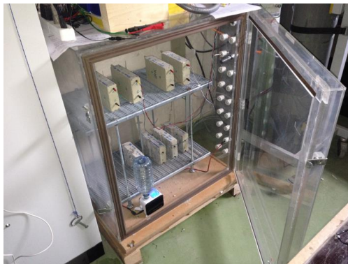
Abb. 70 Messungen an Einzelscheiben der bewehrten Prüfkörpern in der Klimakammer.
