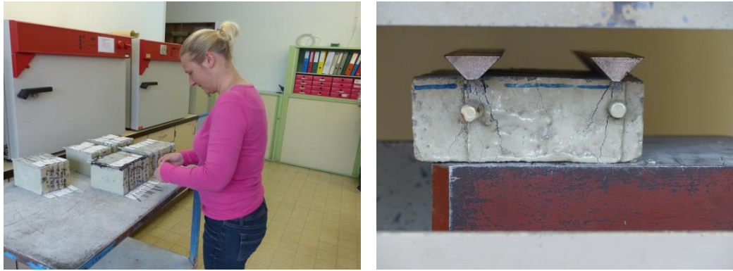
Abb. 96 Vorbereiten und Beschriften der Scheiben (links) und Belastung der Scheiben mit Keilen bis zum Bruch (rechts).
